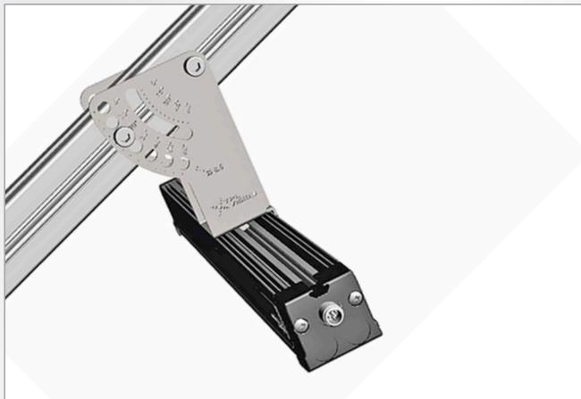
La **Bar BMOUNT** est une fixation ingénieuse, qui permet de fixer les barres à leds TPL Vision dans un système de vision en toute simplicité. Elle donne la possibilité de régler précisément l'angle d'incidence, de 0° à 60°, grâce aux trous prévus à cet effet (tous les 10°).
