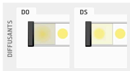
L'Essential EBAR est un éclairage à leds dont la simplicité d'installation et la haute puissance lumineuse en font une barrette essentielle pour la vision industrielle. Utile pour l'éclairage directif d'une surface de forme rectangulaire, on la positionne vers le haut ou vers le bas.
