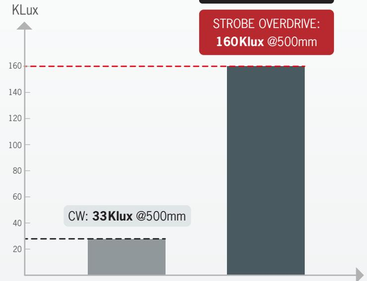
Sortie Lux : différence entre CW et Overdrive
