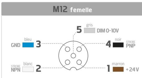
**IMMUNITÉ CEM** : pour une meilleure immunité CEM lors de l'utilisation de l'éclairage en mode Strobe, effectuez les branchements comme indiqué ci-contre. Concernant le dimming, la broche (5) doit être connectée avec une tension comprise entre 0V et 10V afin de garantir un éclairage adéquat.
