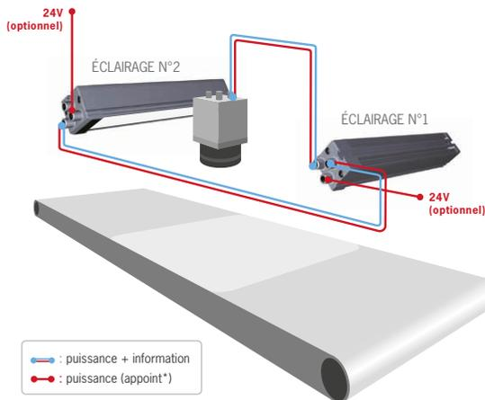
\* Si la sortie éclairage de la caméra ne permet pas de fournir la puissance nécessaire à la barrette, ajoutez 1 appoint de puissance par le 2ème connecteur M12 mâle.
