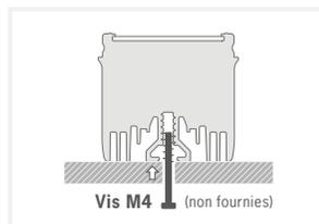
Vous pouvez également utiliser des vis M4 (non fournies) fixées directement dans le profil en aluminium avec un couple de serrage compris entre 0,5 et 1,5 nm. Nous recommandons d'utiliser un frein filet (non fourni) pour éviter tout risque de desserrement.
