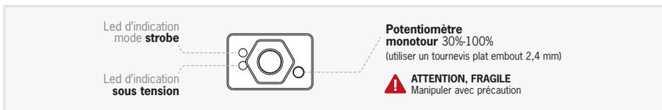
**⚠ OVERDRIVE** : en mode continu, régler le potentiomètre au minimum (30%).
