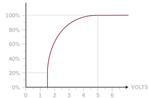
Dimming possible entre 1,5 et 5 Volts.
