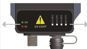
Ceux de droite indiquent **les longueurs d'onde UV** qui ont été sélectionnées par le biais du bouton de sélection. L'indicateur **blanc** WHI s'allumera de manière synchrone avec l'allumage des LED blanches.
