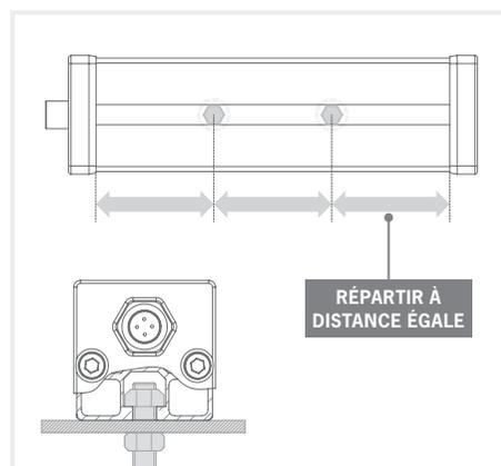
L'éclairage doit être mis en place non raccordé électriquement et donc hors tension. Utiliser les deux écrous livrés avec celui-ci et les introduire dans la rainure à l'arrière de l'éclairage. Pour un meilleur maintien de l'éclairage, répartir les points de fixation comme le schéma ci-dessus l'indique.
