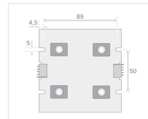
L'éclairage doit être mis en place non raccordé électriquement et donc hors tension. Utiliser les points de fixation prévus à cet effet (voir schéma ci-dessous). L'utilisation de vis M4 (non fournies) est recommandée avec un couple de serrage compris entre 0.5 et 1.5 Nm. Il est préférable d'utiliser un frein filet (non fourni) pour éviter tout risque de desserrement.
