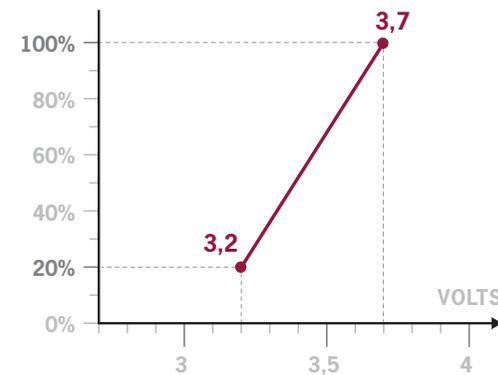
Dimming possible entre 3,2 et 3,7 Volts.
