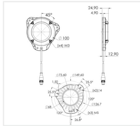
L'éclairage doit être mis en place non raccordé électriquement et donc hors tension. Utiliser les points de fixation prévus à cet effet (voir schéma ci-dessus). L'utilisation de vis M5 (non fournies) est recommandée avec un couple de serrage compris entre 0.5 et 1.5 nm. Il est préférable d'utiliser un frein filet (non fourni) pour éviter tout risque de desserrement.
