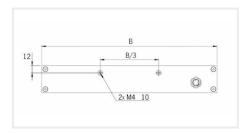
L'éclairage doit être mis en place non raccordé électriquement et donc hors tension. Utiliser les points de fixation prévus à cet effet (voir schéma ci-dessus). L'utilisation de vis M4 (non fournies) est recommandée avec un couple de serrage compris entre 0.5 et 1.5 nm. Il est préférable d'utiliser un frein filet (non fourni) pour éviter tout risque de desserrement.
