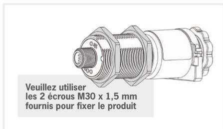
Lors de l'installation, il est impératif de s'assurer que l'éclairage est éteint et débranché pour des raisons de sécurité et une installation correcte.
