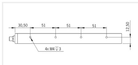
L'éclairage doit être mis en place non raccordé électriquement et donc hors tension. Utiliser les points de fixation prévus à cet effet (voir schéma ci-dessus). L'utilisation de vis M4 (non fournies) est recommandée avec un couple de serrage compris entre 0.5 et 1.5 nm. Il est préférable d'utiliser un frein filet (non fourni) pour éviter tout risque de desserrement.
