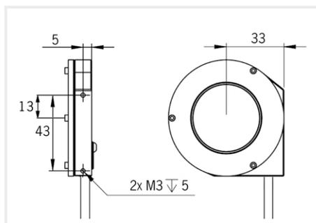
L'éclairage doit être mis en place non raccordé électriquement et donc hors tension. Utiliser les points de fixation prévus à cet effet (voir schéma ci-dessus).
