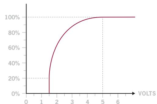
Dimming possible entre 1,5 et 5 Volts.
