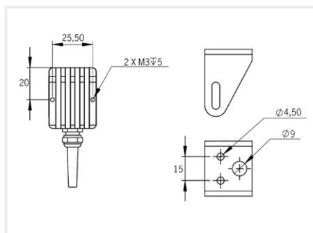
L'éclairage doit être mis en place non raccordé électriquement et donc hors tension. Utiliser les points de fixation prévus à cet effet (voir schéma ci-dessus). L'utilisation de vis M3 (non fournies) est recommandée avec un couple de serrage compris entre 0.5 et 1.5 nm. Il est préférable d'utiliser un frein filet (non fourni) pour éviter tout risque de desserrement.
