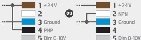
**IMMUNITÉ CEM :** pour une meilleure immunité CEM lors de l'utilisation de l'éclairage en mode Strobe, effectuez les branchements comme indiqué ci-contre. Concernant le dimming, la broche (5) doit être connectée avec une tension comprise entre 0V et 10V afin de garantir un éclairage adéquat.
