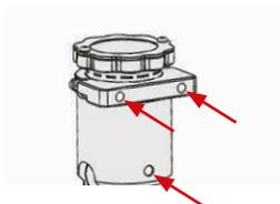
**4)** Validez la bonne orientation de la bague en vérifiant que les 3 points de fixation M4 sont alignés du même côté.
